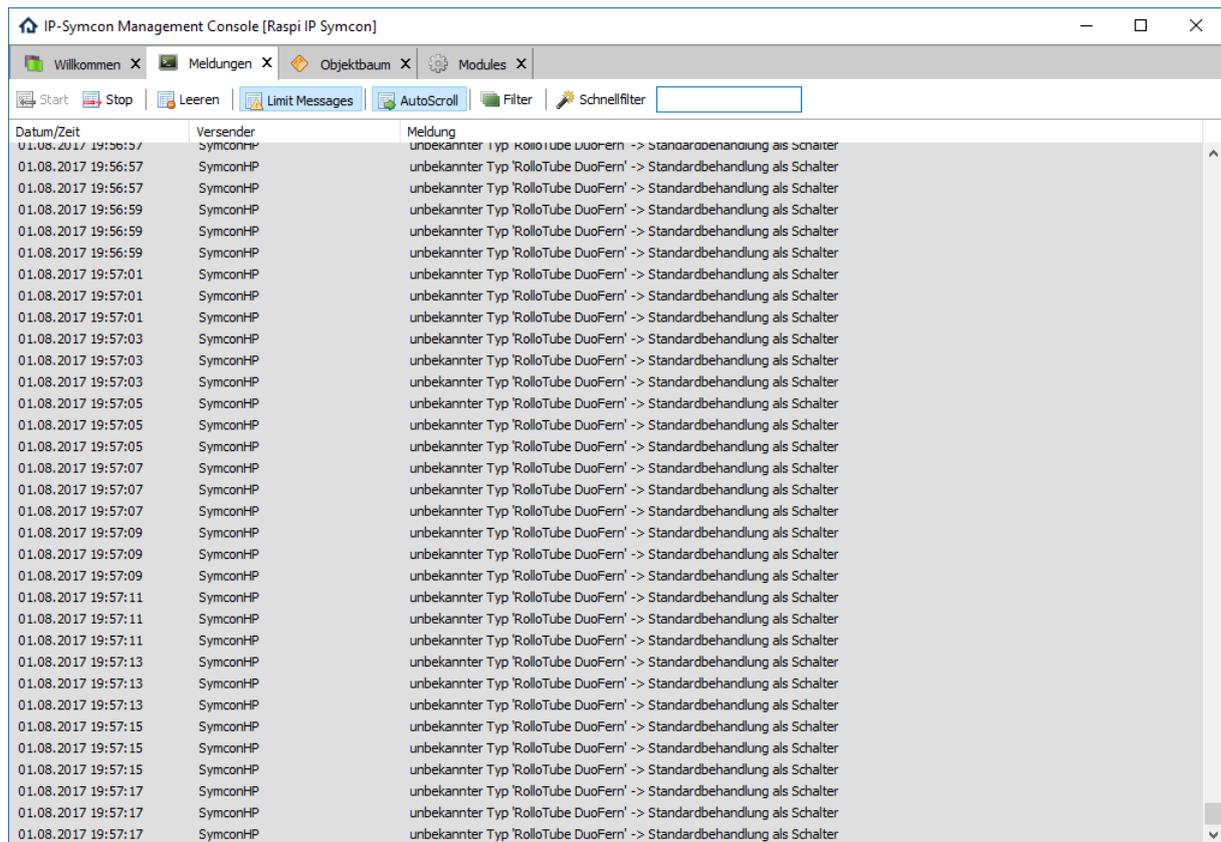
Beispiel für einen Rolladenantrieb RolloTube RTFS 10/16 mit integriertem DuoFern-Empfänger, dieser arbeitet nicht korrekt und vom Modul wurde eine zusätzliche Variable „Schalter“ angelegt
