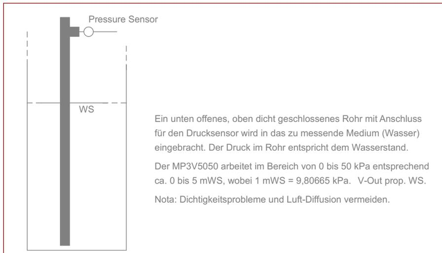
PIN A von DS2450 erhält V-Out von MP3V5050.
