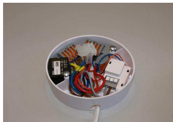
Aufputzdose 27mm, Schaltrelais und Klemme
